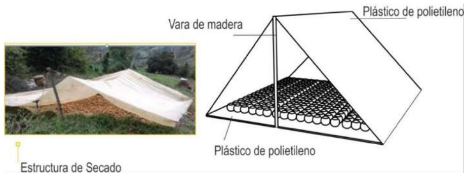
Figura 24 Estructura usada actualmente en las zonas productoras del oriente de Cundinamarca para el secado de cebolla de bulbo.
